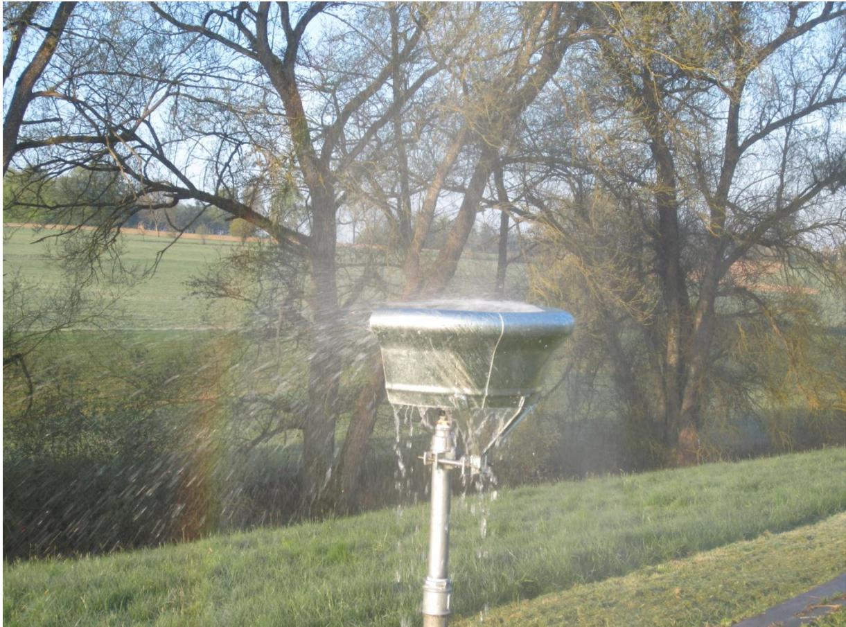
**Abbildung A3: Wirkung der Blende bei schwacher Beregnungsintensität (Nahaufnahme)**
