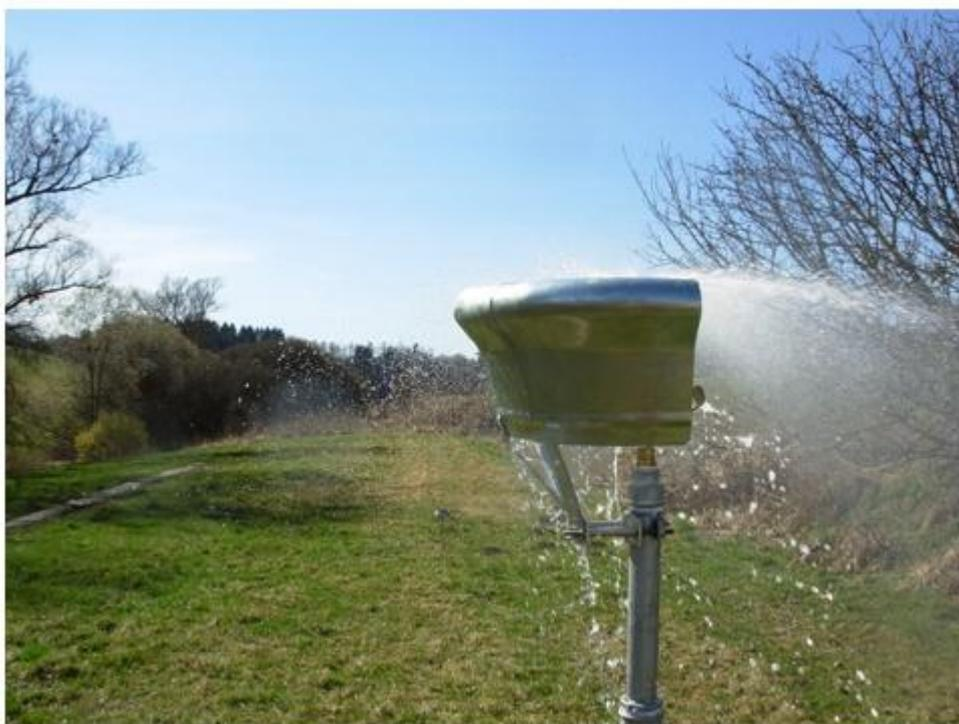
**Abbildung 3: Regnerblende im Einsatz (Versuchsfeld bei Althengstett) bei leichtem Wind**
