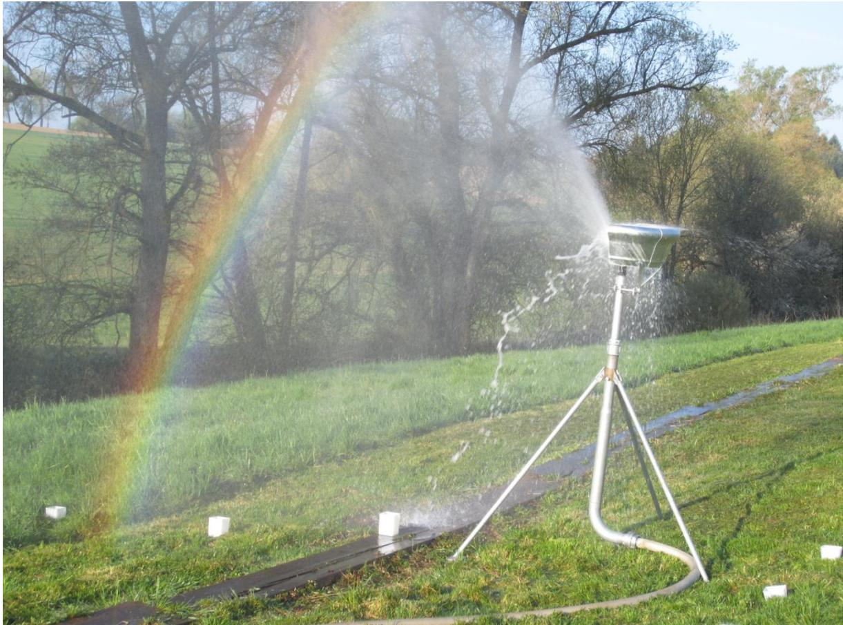
**Abbildung A5:**      **Wirkung der Blende bei mittlerer Beregnungsintensität (Nahaufnahme)**
